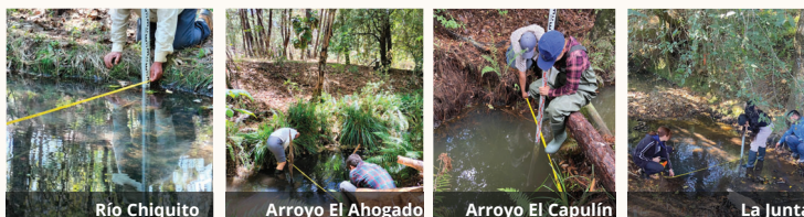
Figura 3. Secuencia de imágenes que ilustra el procedimiento utilizado para medir el caudal en los sitios seleccionados.
