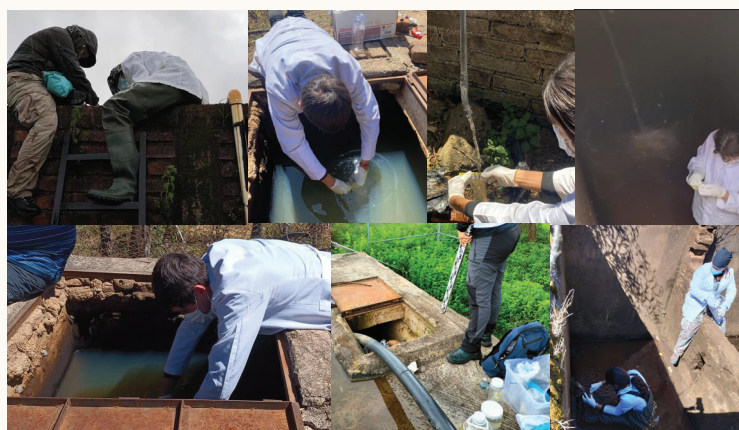
Figura 4 a). Proceso de toma de muestras de agua en los depósitos para el análisis de calidad.
